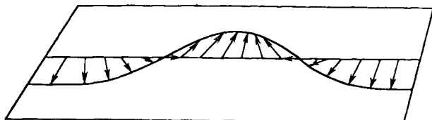
Рис. 6.6. Схематическое изображение солитона в легкоплоскостном ферромагнетике.
