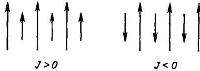
Рис. 4.4. Две основные возможные конфигурации для ферримагнетика.
