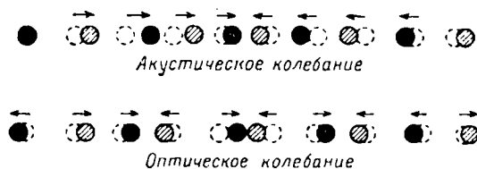
Ф и г. 13. Направления поляризации для акустической и оптической ветвей в линейной цепочке.
