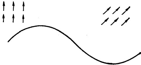
Рис. 8.4. Спиновая волна, вызывающая медленное пространственное изменение направления намагниченности в ферромагнетике.
