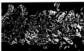
Рис. 7. Двумерное сечение струи, визуализированной красителем, флуоресцирующим в поле лазерного излучения. Число Рейнольдса Re = 4 \cdot 10^4 , изображенная область простирается от 8d до 24d ( d — диаметр струи) (K. R. Greenivasan, 1991).
