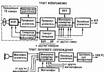
Рис. 4. Структурная схема передающей части монохромной системы вещательного телевидения.
