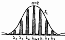
Рис. 2. Искжающее действие «гобогающей» функции J_m на интенсивность результирующих интерференционных максимумов ф-ции J_n в области \lambda_{\text{бл}2} спектра второго порядка.
