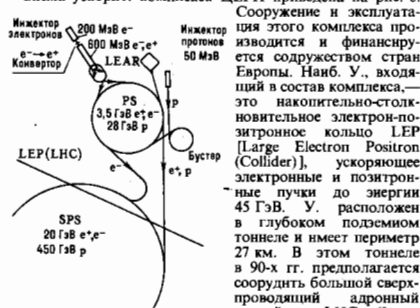
Рис. 6. Схема ускорительного комплекса ЦЕРН (Швейцария).
