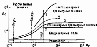
Рис. 3. Области существования различных конвективных режимов в горизонтальном слое подогреваемого снизу жидкостю, построенные на основе обработки экспериментов с различными жидкостями и газами (R. Krishnamurti, 1973).
