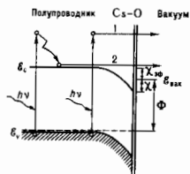
Рис. 3. Энергетическая схема области приповерхностной области полупроводников с ОЭС. Стрелками показан выход в вакуум горячих (1) и термализованных (2) электронов.
