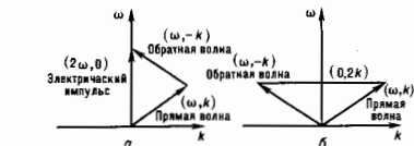
Рис. 3. Дисперсионные диаграммы, поясняющие образование двухимпульсного (а) и трёхимпульсного (б) электроакустического эха.
