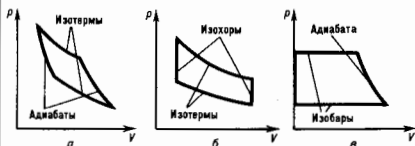
Рис. 8. Термодинамич. циклы в системе координат p — V (объём—давление): а — Карно; б — Клапейрона; в — Клаузиуса—Ранкина.
