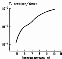
Рис. 1. Спектральная зависимость квантового выхода фотоэмиссии для чистой поверхности Cu.
