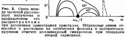
Рис. 3. Связь между частотой рассеянного излучения и направлением его распространения в кристаллах. Штриховые линии относятся к рассеянию на оптич. фононах и поляритах; кружком отмечен коллинеарный синхронизм при генерации второй гармоники.
