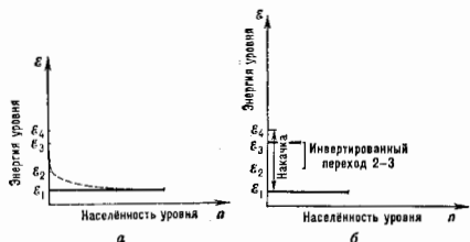
Рис. 2. Накачка четырёхуровневой системы: распределение населённости уровней равновесное (а) и в условиях накачки перехода \mathcal{E}_2 - \mathcal{E}_3 (б).
