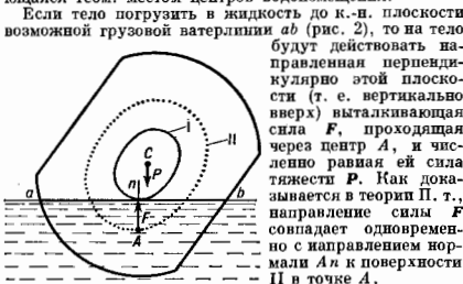
рис. 2. Силы, действующие на тело, погружённое в жидкость до грузовой ватерлинии.
