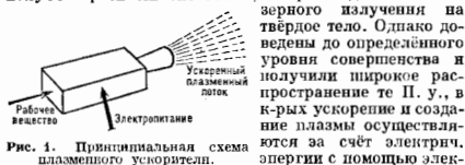
Рис. 1. Принципиальная схема плазменного ускорителя.
