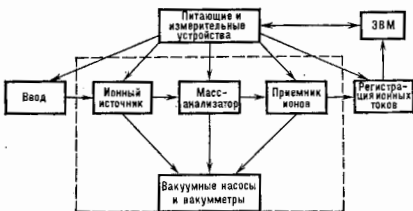
Рис. 1. Блок-схема масс-спектрометра (пунктиром обведена вакуумированная часть прибора).
