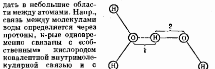
Рис. 1. Схема водородной связи в димере воды: 1 — ионная водородная межмолекулярная связь; 2 — ковалентная связь H — O.
