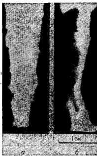
Рис. 2. Обосурпрограмма пинча в плазменном фокусе: а — в режиме с одним сжатием; б — в режиме с двумя сжатиями.
