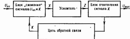
Рис. 2. Блок-схема системы с обратной связью.
