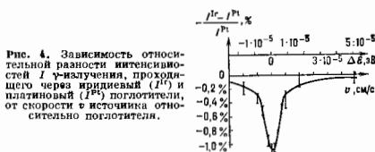
Рис. 4. Зависимость относительной разности интенсивностей I \gamma -излучения, проходящего через резонансный поглотитель, от скорости источника относительно поглотителя.
