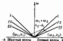
Рис. 7. Дисперсионная диаграмма встречного коллинеарного взаимодействия бездисперсионных акустических волн: быстрой свдвиговой FT и медленной свдвиговой ST с образованием продольной волны L суммарной частоты.
