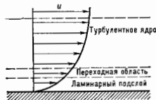
Рис. 5. Внутреннее строение турбулентного пристеночного слоя.
