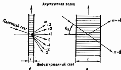
Рис. 8. Схема дифракции света на акустической волне: а — при большом l (пространственная решётка); б — при малом l (плоская решётка).
