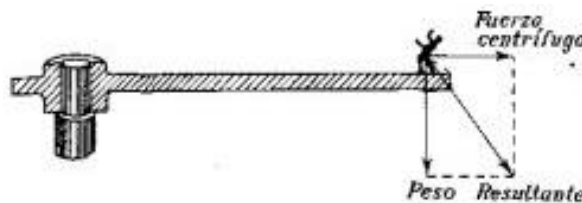
Fig. 37. Fuerzas que actúan sobre una persona que se encuentra en el borde de una plataforma giratoria.
