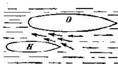
Fig. 71. Corriente de agua entre dos buques que navegan juntos.
