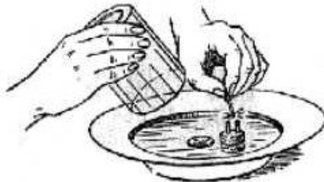
*Fig. 70. Procedimiento para recoger debajo de un vaso invertido todo el agua que hay en un plato*
