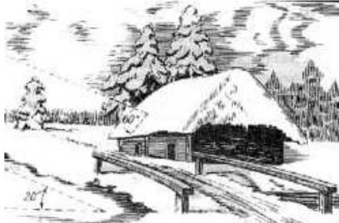
*Fig. 87. Los rayos solares calientan más la vertiente del tejado que la superficie horizontal de la tierra (los números indican el valor de los ángulos).*
