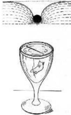
*Fig. 61. La aguja flotando en el agua. Arriba corte de la aguja (de 2 mm de diámetro) y forma exacta de la concavidad que se forma en la superficie del agua (aumentada en 2 veces). Abajo, procedimiento para hacer flotar la aguja por medio de un trozo de papel.*
