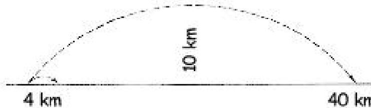
*Fig. 28. El vuelo de una bala en el vacío y en el aire. El arco mayor representa la trayectoria que seguiría la bala si no existiera la atmósfera. El arco menor, la trayectoria real de la bala en el aire*
