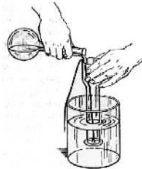
*Fig. 53. Un procedimiento sencillo para convencerse de que los líquidos empujan de abajo a arriba.*
