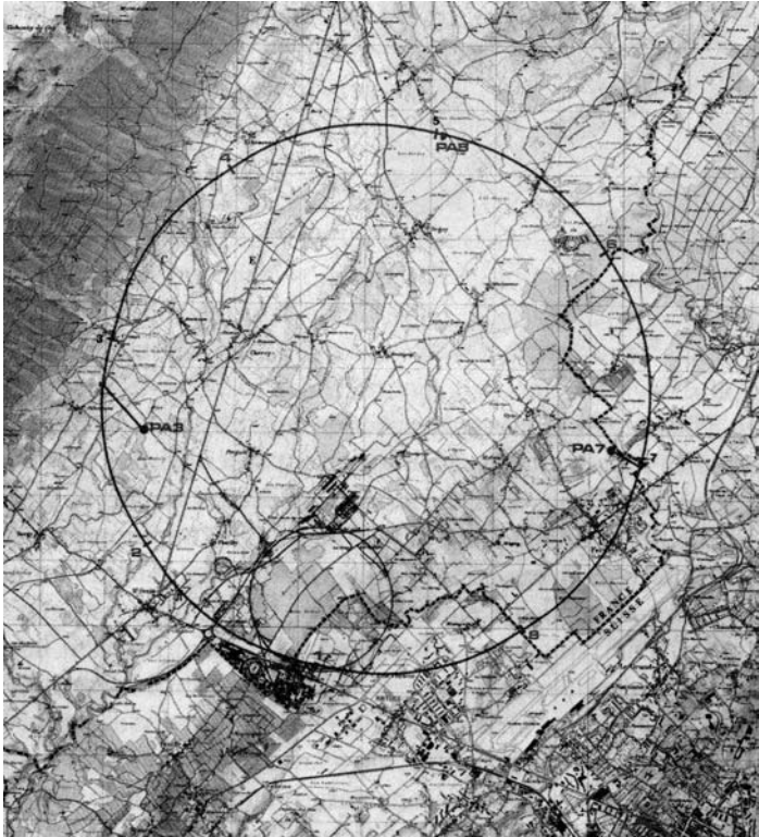
Abb. 19-2 Der ringförmige, 27 km lange Tunnel, in dem sich der LEP-Beschleuniger befindet, verläuft unterirdisch im Genfer Becken zwischen dem Genfer Flughafen und dem Jura. Die angegebenen Ziffern beziehen sich auf die verschiedenen Zonen, in denen man die Elektronen und Positronen zur Kollision bringen kann. Unterhalb des Schnittpunkts der beiden Ringe ist das eigentliche Gelände des CERN eingezeichnet, ebenso der Verlauf des SPS-Beschleunigers. Der LEP-Beschleuniger ist zur Zeit im Bau und wird voraussichtlich 1989 seinen Betrieb aufnehmen. (Abdruck mit freundlicher Genehmigung des CERN.)
