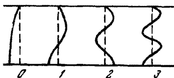
Рис. 35.3. То же, что и на рис. 35.2, но при предположении, что коэффициент отражения от верхней границы равен -1
