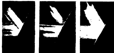
Рис. 14.3. Смещение ультразвукового пучка частоты 1,6 \cdot 10^7 гц при отражении его от границы ксилол-алюминий
