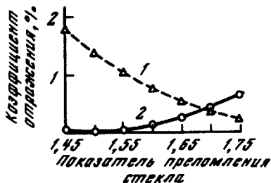
Рис. 16.4. Влияние величины показателя преломления внутреннего слоя при двухслойном просветлении стекла на значение минимального коэффициента отражения, осуществляющегося при четвертьволновых слоях. Показатель преломления верхнего слоя 1,47, стекла 1,525
