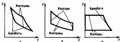
Рис. Термодинамич. циклы в системе координат p — V (объём—давление): а—Карно; б—Клапейрона; в—Клаузиуса—Ранкина.
