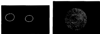
Рис. 7. Магнитные домены на пластинках смешанных ферритогранатов с плоскостью поверхности, перпендикулярной к ОЛН: слева — кольцевые домены; справа — спиральные домены (по данным Ю. Л. Губова). В светлых и тёмных областях M имеют противоположные направления, перпендикулярные к плоскости пластины.
