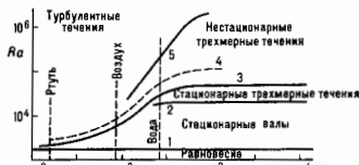
Рис. 3. Области существования различных конвективных режимов в горизонтальном слое подогреваемой снизу жидкости, построенные на основе обработки экспериментов с различными жидкостями и газами (R. Krishnamurti, 1973).
