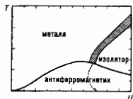
Рис. 3. Фазовая диаграмма при n=1 и d \rightarrow \infty на плоскости (T, U) [6].
