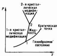
Тройные точки (1 и 2) на диаграмме состояния в координатах P-T (давление — температура).
