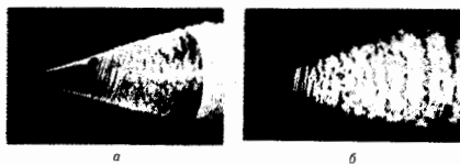
Рис. 8. Развитие турбулентности из спиральных вихрей, формирующихся в пограничном слое при обтекании вращающегося конуса: а) U = 1.7 м/с; n = 670 об/мин; б) U = 1.0 м/с; n = 1200 об/мин. Здесь U — скорость набегающего потока, n — частота вращения (R. Kobayashi, L. Kohama, M. Kurosawa, 1983).
