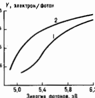
Рис. 2. Спектральная зависимость квантового выхода фотоэмиссии для сильнолегированного кремния n - и p -типов ( \phi_p = 1,1 эВ, \chi = 4 эВ); — n -тип, 2 — p -тип.
