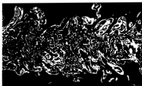
Рис. 7. Двумерное сечение струи, визуализированной красителем, флуоресцирующим в поле лазерного излучения. Число Рейнольдса Re = 4 \cdot 10^3 , изображённая область простирается от 8d до 24d ( d — диаметр струи) (K. R. Greenivasan, 1991).
