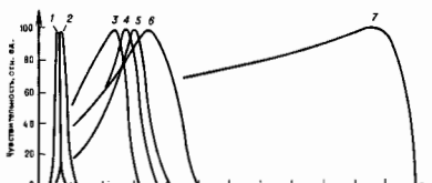
Рис. 2. Кривые спектральной чувствительности фоторезисторов на основе CdS (кривая 1), CdSe (2), PbS (3), твёрдого раствора PbS—PbSe (4, 5), PbSe (6), PbSn(Te) (7).
