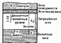
Рис. 2. Зональная диаграмма ионного кристалла.
