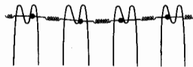
Конфигурационная потенциальная энергия атомов «подвижной» подрешётки в поле атомов «неподвижной» подрешётки (одномерный случай).
