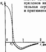
Рис. 2. Схематический вид центрального NN-потенциала с жёстким кором (сплошная линия) и с мягким кором (штриховая линия); r — расстояние между нуклонами, r_c — радиус жёсткого кора.
