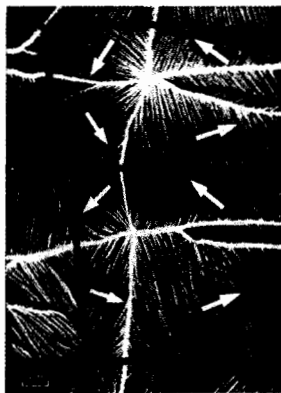
Рис. 5. Изображение доменной структуры тонкой однородной по толщине пермальевой плёнки. Снято в просвечивающем электронном микроскопе при дефокусировке изображения (метод лоренцевой электронной микроскопии). Светлые и тёмные полосы—границы доменов. Видна «яркая» намагниченности, возникающая вследствие малых изменений направлений векторов намагниченности (отмечены стрелками) внутри доменов.
