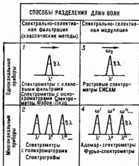
Рис. 2. Классификация методов спектрометрии по числу каналов и способам разделения длин волн. Контуры шириной \delta\lambda символизируют изображения аппаратной функции (АФ). В одноканальных методах (1 и 3) применяется сканирование (символ \rightarrow ), в многоканальных (2 и 4) — сканирование отсутствует и всемерное интенсивности излучения ряда длин волн \lambda' , \lambda'' , \lambda''' , ... проводится одновременно.
