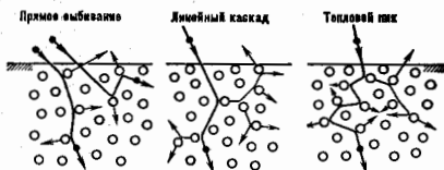
Рис. 5. Режимы столкновительного рассеяния.
