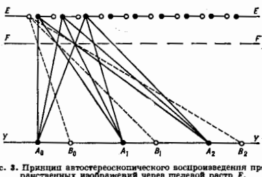
Рис. 3. Принцип автостереоскопического воспроизведения пространственных изображений через щелевой растр F.
