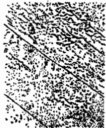
Рис. 2. Субструктура, возникшая в результате отжига изогнутого монокристалла кремнистого железа (3,4,5б). AA — субграница с большой плотностью дислокаций; BB — субграница с малой плотностью дислокаций. Увеличение 500.
