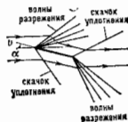
Рис. 4. Схема обтекания пластины сверхзвуковым потоком.
