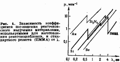
Рис. 4. Зависимость коэффициента поглощения рентгеновского излучения материалами, используемыми для изготовления рентгеношаблонов, и стандартного резиста (ПММА) от \lambda .
