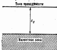
Рис. 1. Зонная схема полупроводника (состояния, заполненные электронами, заштрихованы).
