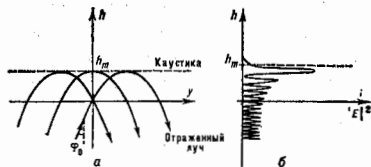
Рис. 1. а — рефракция радиоволн в плоскослойной среде о град \pi < \theta ; б — зависимость квадрата амплитуды напряжённости электрического поля радиоволн от высоты h .
