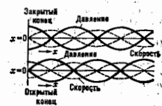
Распределение давлений и скоростей в стоячей волне при открытом и закрытом концах не лучающей звуковой трубе.
