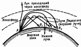
Рис. 9. Схематическое изображение радиоволны определенной частоты при различных углах падения на ионосферу.
