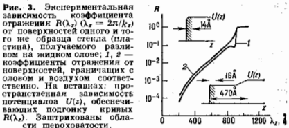
Рис. 3. Экспериментальная зависимость коэффициента отражения R(k_z) ( \Delta x = 2\pi/k_z ) от поверхности одного и того же образца стекла (пластина), получаемого излучением на низком оловне; 1, 2 — коэффициенты отражения от поверхности, граничащих с оловом и воздухом соответственно. На вставках: пространственная зависимость потенциалов U(z) , обеспечивающая подложку кривых R(k_z) . Загнтрированы области шероховатости.
