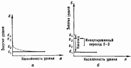
рис. 2. Накачка четырёхуровневой системы: распределение населенностей уровней равновесное (а) и в условиях накачки перехода \varphi_1 - \varphi_4 (б).
