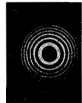
Рис. 1. Кольца Ньютона в отраженном свете.
