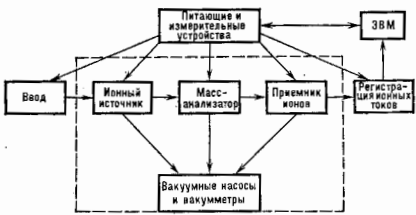
Рис. 1. Блок-схема масс-спектрометра (пузырчатком обесч. вакуумированная часть прибора).
