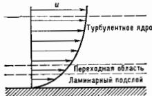
Рис. 5. Внутреннее строение турбулентного пограничного слоя.
