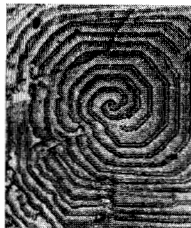
Рис. 9. Двухядерная спираль, образующая вициальный холмик вокруг точек выхода на поверхность двух дислокаций: а) общий вид холмика; б) его сечение плоскостью, перпендикулярной грани и проходящей через точки выхода дислокаций; в) спираль на грани (100) синтетического алмаза.
