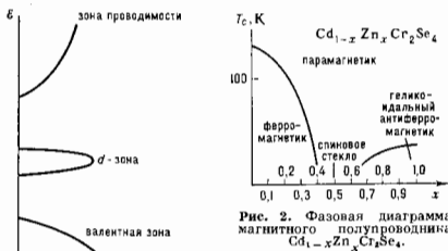
Рис. 1. Зонная структура магнитных полупроводников.
