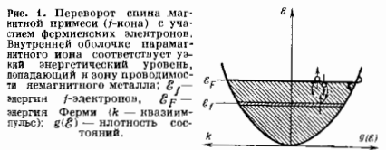
Рис. 1. Переворот спина магнитной примеси ( f -иона) с участием фермионских электронов. Внутренней оболочке парамагнитного иона соответствует узкая энергетическая зона, попадающая в зону проводимости немагнитного металла; \epsilon_f — энергия f -электронов, \epsilon_F — энергия Ферми ( k — квазиимпульс); g(\epsilon) — плотность состояний.
