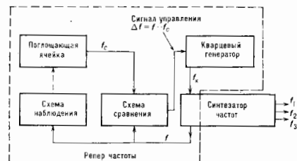
Рис. 2. Блок-схема пассивного стандарта частот.
