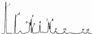
Рис. 1. Инфракрасный спектр излучения руды. 1—12 — спектральные линии, длины волн которых в мкм равны: 1 — 1,014; 2 — 1,129; 3 — 1,357; 4 — 1,387; 5 — 1,395; 6 — 1,530; 7 — 1,692; 8 — 1,707 и 1,711; 9 — 1,814; 10 — 1,970; 11 — 2,249; 12 — 2,326.
