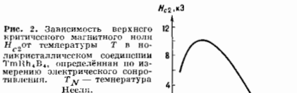
Рис. 2. Зависимость верхнего критического магнитного поля H_{c2} от температуры T в неоднородном магнитном соединении \text{TmRh}_2\text{B}_4 , определенная по измерению электрического сопротивления. T_M — температура Несси.
