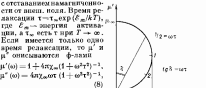
Рис. 3. Диаграмма Аржана (или Коле и Коле) зависимости \mu = f(\mu') .
