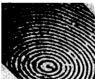
Рис. 10. Интерференционные полосы от вискозного столбика на грани призмы кристалла ADP (рост из водного раствора).
