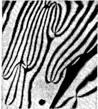
Рис. 5. Дисклинация в нематических жидких кристаллах: а — дисклинация (указаны стрелками), наблюдаемые в изотропизированном микроскопе; жирные линии, выходящие из острия хвоста комет, — области, где директор плавно изменяет ориентацию; б — ориентация молекул в окрестностях точек выхода дисклинация на плоскость рис.
