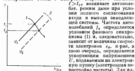
Рис. 3. Дисперсионные характеристики обратной электромагнитной волны 1 и высокочастотных электронных волн в пучке 2.
