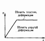
Рис. 6. Зависимость между напряжениями \sigma и деформацией \epsilon при упругопластическом изгибе бруса.
