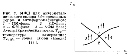
Рис. 7. МФД для интерметаллического сплава 3d-переходных ферро- и антиферромагнетиков: 1 — ПМ-фаза; 2 — СС-фаза; 3 — ФМ-фаза; 4 — АФМ-фаза; A — тройная точка; T_{СС} — температура замерзания; T_{C,N} — точка Кюри (Неэли) [11].
