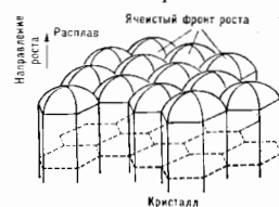
Рис. 13. Схема ичестной структуры фронта кристаллизации.
