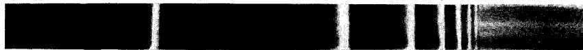
Рис. 1. Экситонный спектр поглощения Cu_2O (пластинки толщиной 60 мкм) при 4,2 К. Видны члены серии, начиная с n=3 ( \lambda=573,3 нм).
