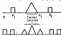
Рис. 7. Форма выходного сигнала V_4 при свёртке: а — двух прямоугольных и б — двух пар прямоугольных импульсов V_1 и V_2 .
