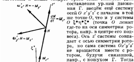
Рис. 5. Приложение теоремы механики системы о кинетическом моменте и установлению уравнения прецессионного движения ротора гироскопа. Скорость конца вектора собственного кинетического момента принимается геометрически равной главному моменту совокупности сил, приложенных к ротору.
