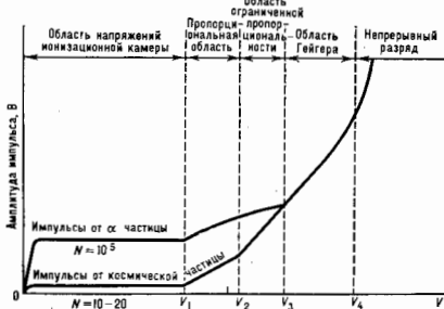
Зависимость амплитуды импульсов, вырабатываемых ионизационными детекторами, от напряжения на электродах в случае прохождения через детектор быстрой ионизирующей частицы, образующей N \approx 10 — 20 пар ионов, и \alpha -частицы, создающей N \approx 10^5 пар ионов.
