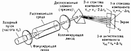
Рис. 1. Типичная схема опыта по наблюдению вынужденного комбинационного рассеяния света.
