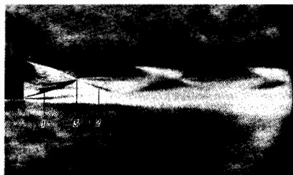
Рис. 3. Тевевая фотография осесимметричной сверхзвуковой нерасчётной затопленной струи: 1 — висячая ударная волна; 2 — отражённые ударные волны; 3 — область отражения ударных волн.
