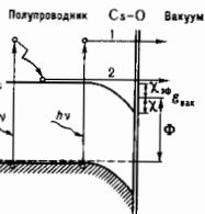
Рис. 3. Энергетическая схема приповерхностной области полупроводника с ОЭС. Стрелками показан выход в вакуум горячих (1) и термализованных (2) электронов.
