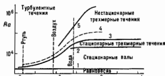
Рис. 3. Области существования различных конвективных режимов в горизонтальном слое подогреваемой снизу жидкости, построенные на основе обработки экспериментов с различными жидкостями и газами (R. Krishnamurti, 1973).
