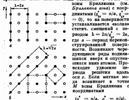
рис. 4. Примеры реконструированной поверхности (100) кубического кристалла: а — реконструкция за счёт мягкой моды в точке X зоны Бриллюэна; новая элементарная ячейка показана пунктиром; б — реконструкция за счёт мягкой моды в точке M зоны Бриллюэна; новая элементарная ячейка показана пунктиром.
