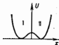
Рис. 5. Потенциальный рельеф, в котором происходит движение ионов в упорядоченной подрешётке в системах типа порядок — беспорядок.
