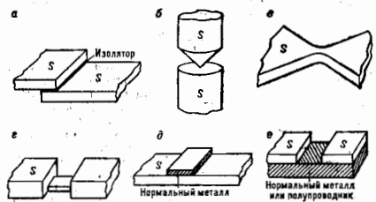
Рис. 1. Слабосвязанные сверхпроводники различных типов: а — туннельный джозефсоновский контакт; б — точечный контакт; в — мостик переменной толщины; г — плёнка из сверхпроводника с узкой полоской нормального металла; е — две близко расположенные плёнки, нанесённые на плёнку из нормального полупроводника.
