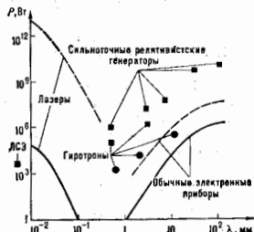
Мощность генераторов когерентного электромагнитного излучения в зависимости от длины волны; ● — непрерывный режим, ■ — импульсный режим.
