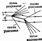
Рис. 4. Схема обтекания пластины сверхзвуковым потоком.
