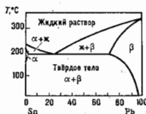
Рис. 6. Фазовая диаграмма системы Zn — Pb эвтектического типа. \alpha , \beta — твёрдые растворы. Точка пересечения трёх линий, в которых сосуществуют жидкая и две твёрдые фазы, — точка эвтектики.
