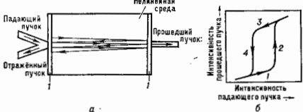
Рис. 6. Интерферометр Фабри — Перо как оптич. нестабильный элемент (а) и петля гистерезиса зависимости интенсивности прошедшего луча от интенсивности падающего луча (б): 1 — полупрозрачное зеркало.
