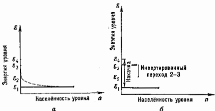
рис. 2. Накачка четырёхуровневой системы: распределение населённости уровней равновесное (а) и в условиях накачки перехода \varphi_1 - \varphi_4 (б).
