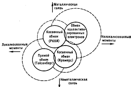
Схема, иллюстрирующая связь четырех различных основных механизмов обмена в кристаллах с металлической (её преобладание указано вертикальной стрелкой, направленной вверх) и неметаллической (вертикальная стрелка, направленная вниз) связями для локализованных (горизонтальная стрелка, направленная влево) и не локализованных (горизонтальная стрелка, направленная вправо) моментов. Каждый тип обмена представляет двумя концентрическими окружностями; из них внутренняя окружность (сплошная линия) представляет основную область действия данного типа обмена, а внешняя (пунктирная линия) — возможную область (подчиненного) действия.
