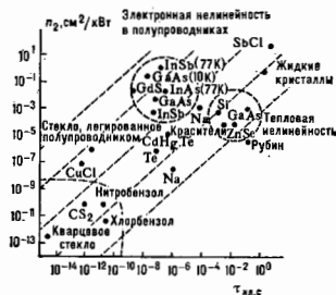
Рис. 3. Значения нелинейного коэффициента n_2 для оптических материалов на плоскости n_2, \omega_{нлд} .
