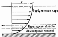
Рис. 5. Внутреннее строение турбулентного пограничного слоя.
