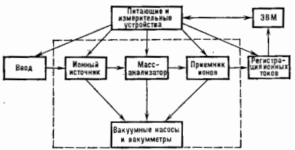
Рис. 1. Блок-схема масс-спектрометра (пузырчаткой обозначена вакуумированная часть прибора).
