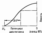
Рис. 2. Зависимость яркости свечения экрана Э от потенциала диэлектрика.
