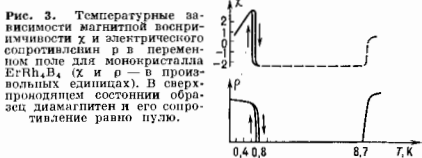
Рис. 3. Температурные зависимости магнитной восприимчивости \chi и электрического сопротивления \rho в переменном поле для монокристалла \text{ErRh}_2\text{B}_4 ( \chi и \rho — в произвольных единицах). В сверхпроводящем состоянии образцы диамагнитны и его сопротивление равно нулю.
