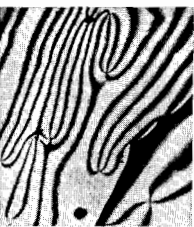
Рис. 5. Дисклинация в нематических жидких кристаллах: а — дисклинация (указаны стрелками), наблюдаемые в изотропизированном микроскопе; жирные линии, выходящие из острия комет, — области, где директор плавно изменяет ориентацию; б — ориентация молекул в окрестности точек выхода дисклинация на плоскость рис.
