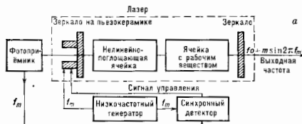
Рис. 3. Блок-схема оптического стандарта частоты: а — с внешним репером; б — внутренним. Автоподстройка и резонаторы необходимы для увеличения эффекта затягивания частоты.
