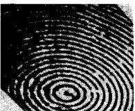
Рис. 10. Интерференционные полосы от внешнего кольца на грани призма кристалла ADP (рост из водного раствора).
