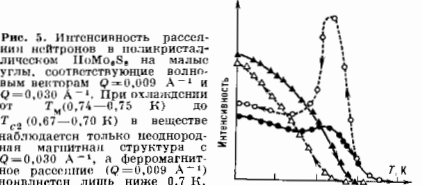
Рис. 5. Интенсивность рассеяния нейтронов в поликристаллическом \text{HoMo}_2\text{S}_8 на малых углах, соответствующие волновым векторам Q = 0,009 \text{ \AA}^{-1} и Q = 0,030 \text{ \AA}^{-1} . При охлаждении от T_M (0,74 - 0,75 \text{ K}) до T_{C2} (0,67 - 0,70 \text{ K}) в веществе наблюдается только неоднородная магнитная структура с Q = 0,030 \text{ \AA}^{-1} , а ферромагнитное рассеяние ( Q = 0,009 \text{ \AA}^{-1} ) поднимается лишь ниже 0,7 \text{ K} .
