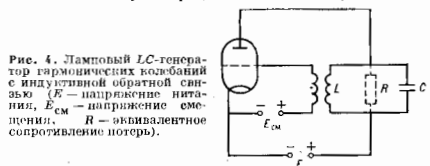
Рис. 4. Ламповый LC -генератор гармонических колебаний с индуктивной обратной связью ( E_{\text{см}} — напряжение питания, E_{\text{л}} — напряжение смещения, R — эквивалентное сопротивление лампы).
