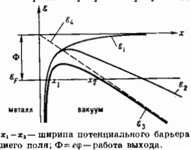
Рис. 1. Потенциальная энергия \Phi и энергия \mathcal{E} вблизи поверхности металла. \mathcal{E}_1 — отсутствие электрического поля; \mathcal{E}_2 — обусловленная слабым внешним электрическим полем; \mathcal{E}_3 — более сильным полем; \mathcal{E}_4 — энергия, соответствующая отсутствию сил изображения в случае сильного поля; \mathcal{E}_F — энергия Ферми; x_1 , x_2 — ширина потенциального барьера при наличии внешнего поля; \Phi и \varphi — работа выхода.
