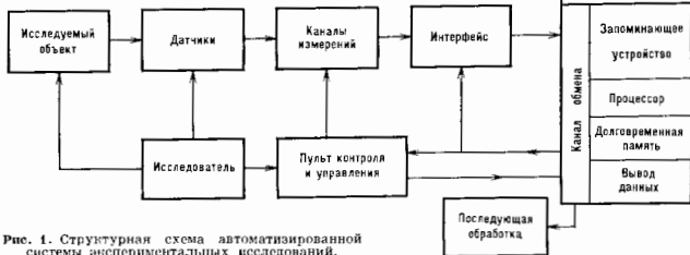
Рис. 1. Структурная схема автоматизированной системы экспериментальных исследований.
