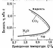
Рис. 2. Характер температурной зависимости вязкости вещества в жидком и газообразном состояниях.
