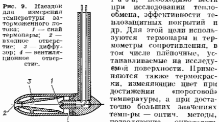
Рис. 9. Насадок для измерения темп-ратуры заторможенного потока: 1 — снай терморезистор; 2 — входное отверстие; 3 — диффузор; 4 — вентиляционное отверстие.
