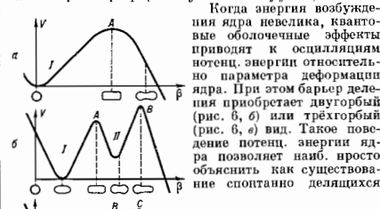
Рис. 6. Потенциальная энергия V ядра как функция параметра деформации \beta , характеризующего его форму в процессе деления. Визу — схематическое изображение эволюции формы ядра в процессе деления.
