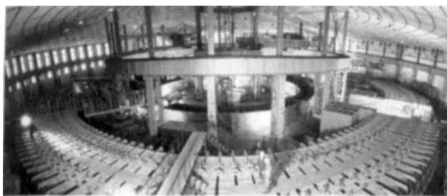
Гигантский ускоритель протонов в Дубне — синхрофазотрон на 10 млрд электронвольт.
