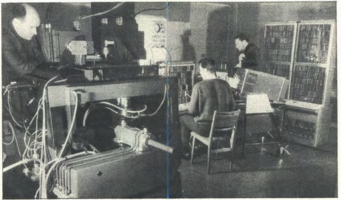
Рис.116. Введена в действие оптико-механическая часть автомата с механическим сканированием и изготовлена большая часть блоков электронных устройств для него. Автомат предназначен для высокоскоростной обработки фотографий с пузырьковых камер при работе в режиме непосредственной связи с электронной вычислительной машиной. На снимке (слева направо): механик А.С.Буров, начальник отдела автоматизации Ю.А.Каржавин, ст.инженер В.В.Ермолаев.
