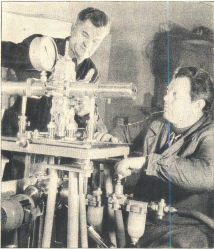
Рис.23. Установка для исследования короткоживущих \alpha -активных трансфермиевых элементов. Продукты реакций собираются на тонкие сборники, позволяющие проводить эксперименты в геометрии, близкой к 4\pi .
