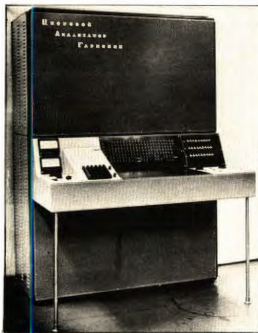
Рис.110. Специальная вычислительная машина, предназначенная для гармонического анализа магнитных полей циклических ускорителей.
