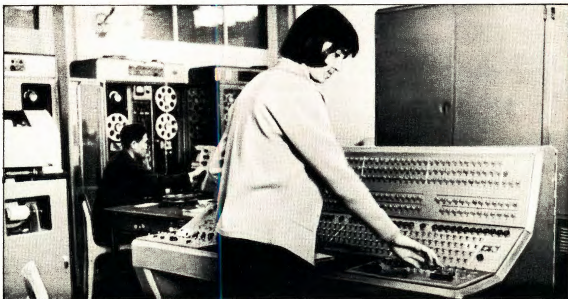
Рис. 88. Полупроводниковая вычислительная машина БЭСМ-3М предназначена для работы "на линии" с измерительными полуавтоматами. Прием данных от полуавтоматов осуществляется в режиме прерывания. На снимке: ст. инженер И.Н.Кухтина у пульта БЭСМ-3М.
