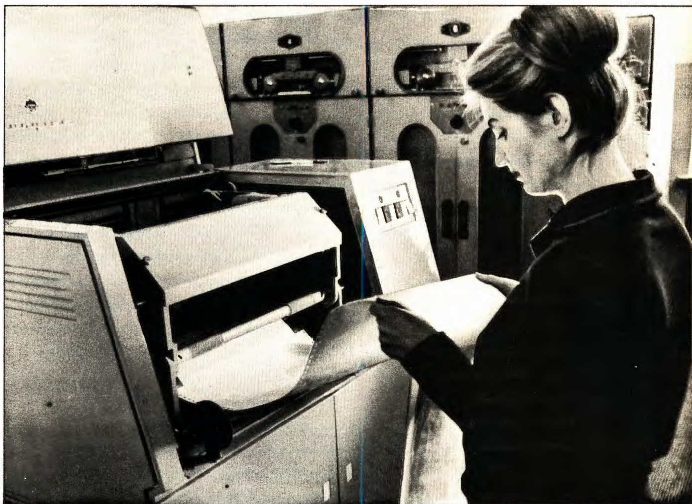
Рис. 85. На вычислительной машине „Минск-22“ установлено устройство широкой печати. С его помощью можно выводить из машины текстовую информацию. Длина строки - 128 позиций. На снимке: техник Н.Б.Безрукова проверяет качество пленки.
