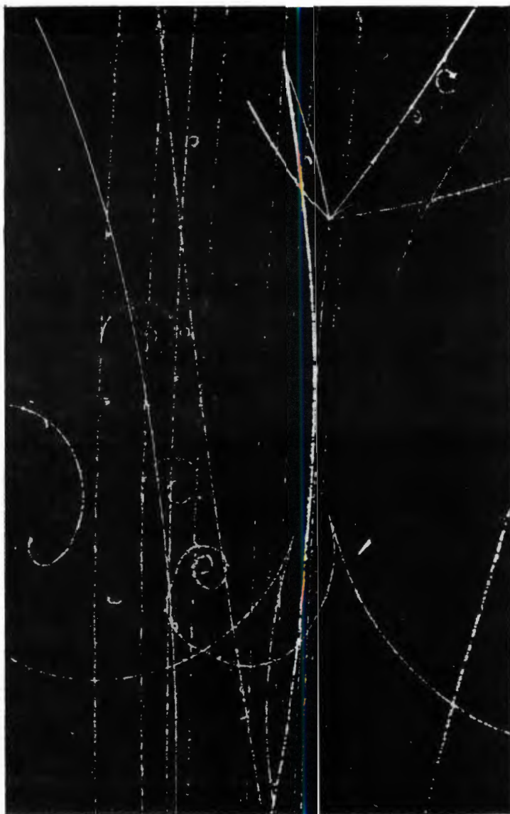
Рис. 46. Фотография трех \gamma -квантов от O-лучевой звезды в 2-метровой протонной камере.
