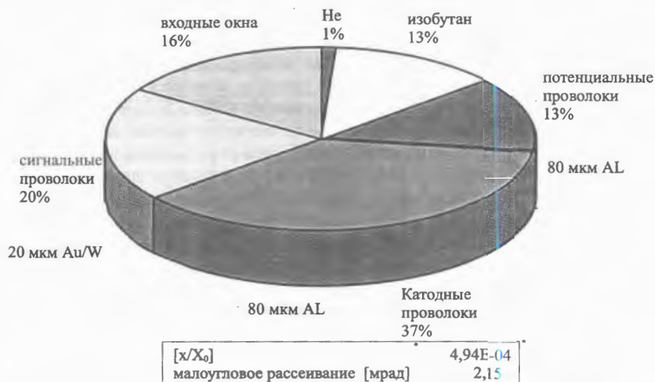
Рис. 3. Вклад многократного рассеяния от различных материалов, присутствующих в активном объеме дрейфовых камер
