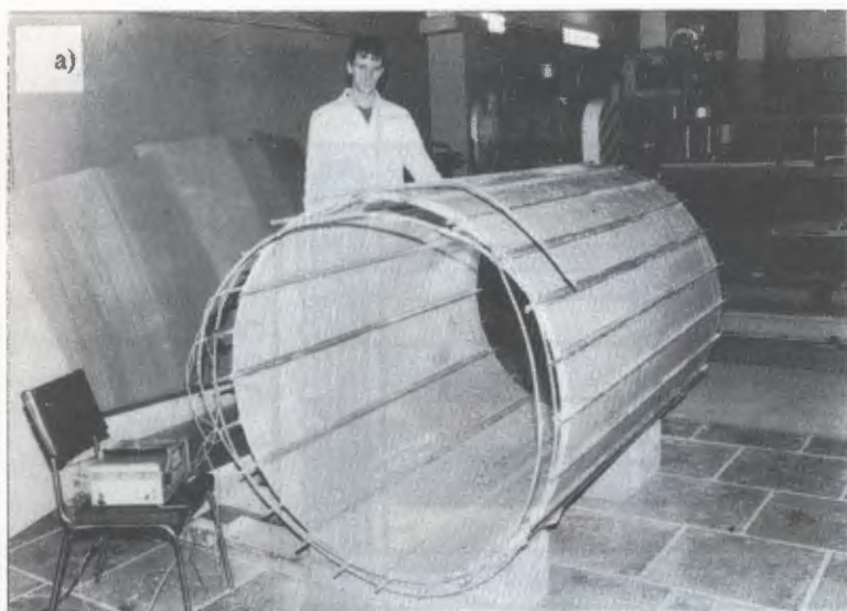
Рис.5. Сверхпроводящий соленоид установки АМПИР: а) внешний вид катушки соленоида; б) двухслойная обмотка в разрезе: зазоры между витками ( \sim 0,4 мм) заполнены хлопчатобумажной изоляцией, пропитанной КРИОСИЛом
