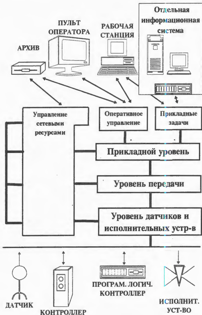
Рис.7. Модель системы, основанной на использовании стандарта Fieldbus
