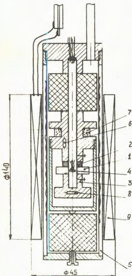
Рис. 1. Схема измерительной части штока.
