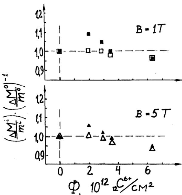
Рис.2. Зависимость внутримеренной критической плотности тока от флюенса для случаев, когда магнитное поле параллельно трекам (сплошные значки) и перпендикулярно им.
