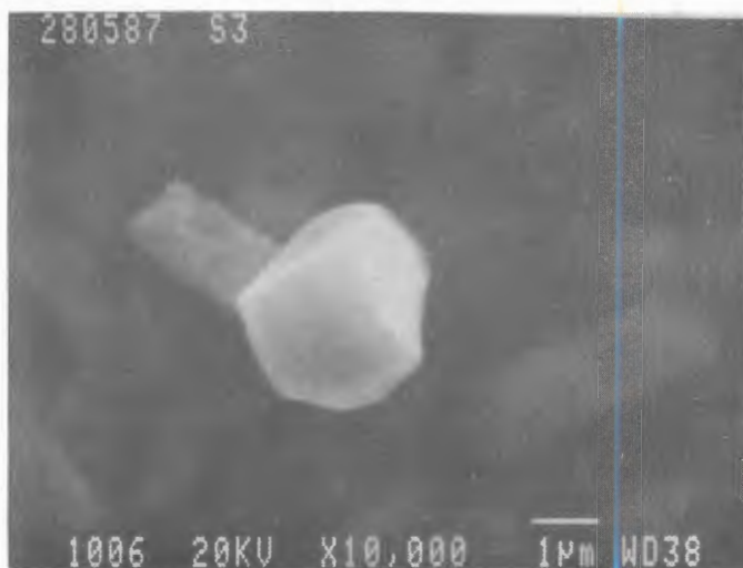
Рис.2а. Фотография поверхности сверхпроводника Y_1Ba_2Cu_3O_{7-\delta} до облучения.
