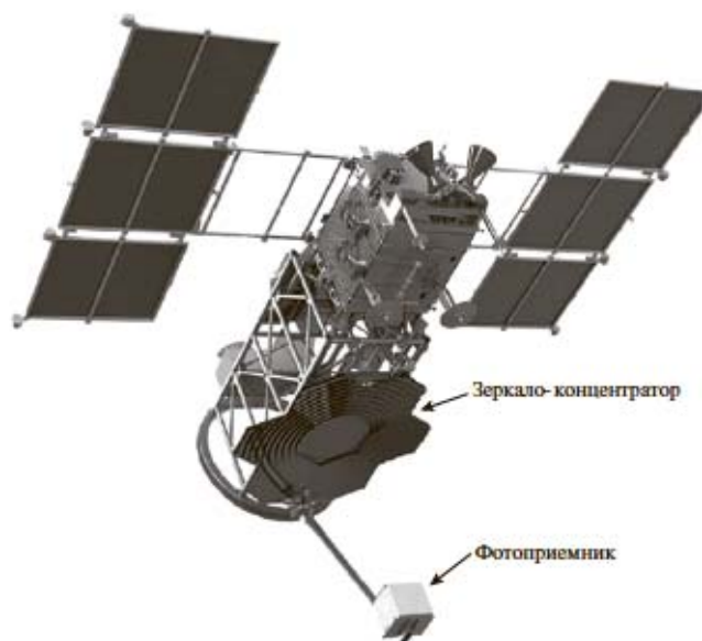
Рис. 1. Схематический вид детектора ТУС на борту спутника "Ломоносов".
