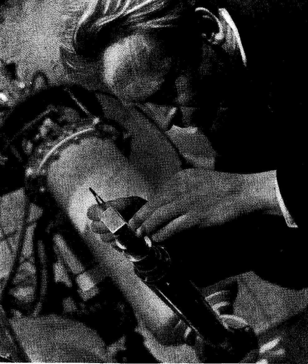
ХОЛОДИЛЬНАЯ УСТАНОВКА Б. С. НЕГАНОВА ИСПОЛЬЗУЕТСЯ ДЛЯ ОПЫТОВ С ПОЛЯРИЗОВАННЫМИ ЧАСТИЦАМИ. ОНА СПОСОБНА КАК УГОДНО ДОЛГО ПОДДЕРЖИВАТЬ ТЕМПЕРАТУРУ, БЛИЗКУЮ К АБСОЛЮТНОМУ НУЛЮ.
