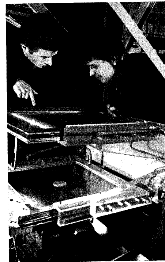
УСТАНОВКА ИЗ ПРОВОЛОЧНЫХ ИСКРОВЫХ КАМЕР ДЛЯ ИЗМЕРЕНИЯ КООРДИНАТ И УГЛОВ ТРАЕКТОРИЙ ЗАРЯЖЕННЫХ ЧАСТИЦ. СЪЕМ ДАННЫХ ОСУЩЕСТВЛЯЕТСЯ МАГНИТОСТРИКЦИОННЫМ МЕТОДОМ.
