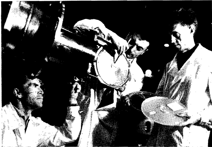
СБОРКА ЭКСПЕРИМЕНТАЛЬНОЙ УСТАНОВКИ ДЛЯ РЕГИСТРАЦИИ СПОНТАННОГО ДЕЛЕНИЯ ТРАНСУРАНОВЫХ ЯДЕР.
