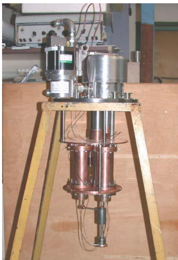
Рисунок 6 – Схематический чертеж рефрижератора и его фотография на монтажно-наладочном стенде
