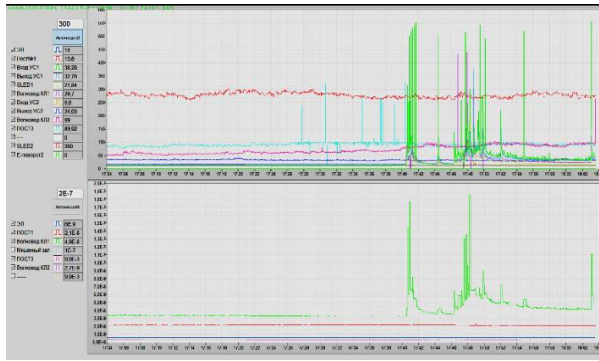
Рис. 12. Интерфейс вакуумной системы на операторском мониторе пульта управления с графиками токов магниторазрядных насосов (верхние графики) и графиками показаний вакуумных сенсоров (нижние графики)
