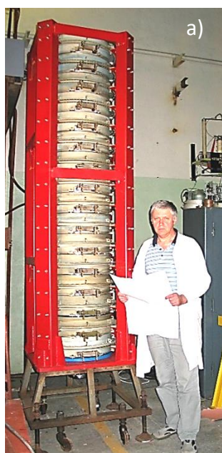
Рис. 7. Общий вид соленоида первой ускоряющей секции: а – на стенде при контрольной сборке, б – на ускорителе
