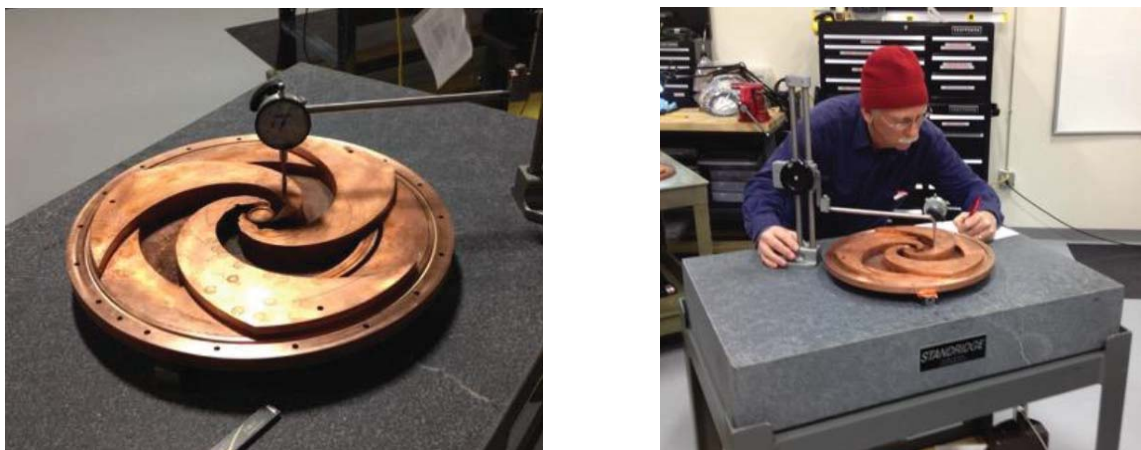
Рис. 2. Изготовленная секторная структура циклотрона ION-12SC [A13].
