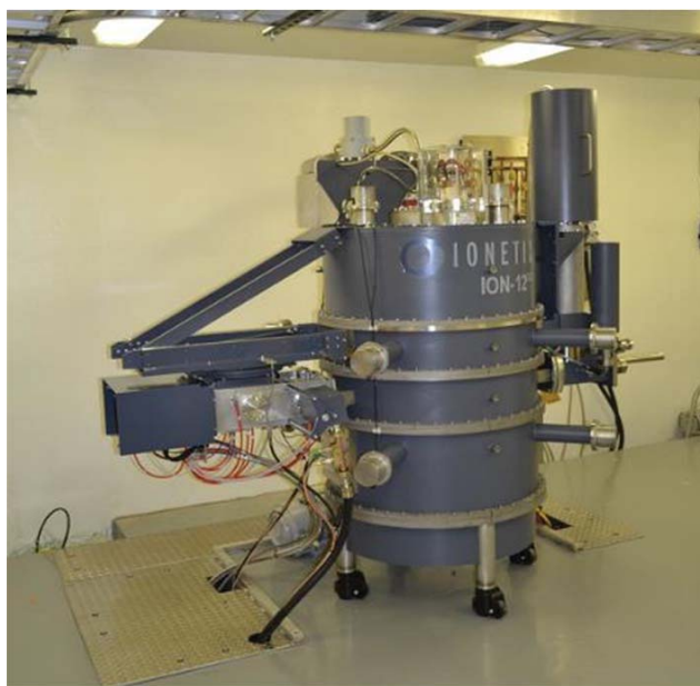
Рис. 1. Ускоритель в сборе. Циклотрон расположен внутри криостата [A13].
