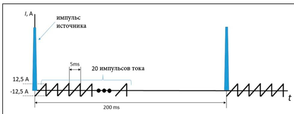
Рис. 8. Временная зависимость импульсов тока, протекающего в спиновых ротаторах.
