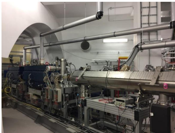
Рисунок 5 Схема линейного ускорителя ЛУТИ с анализирующим магнитом для измерения выходной энергии ионов (вверху) и вид ЛУТИ (внизу)
