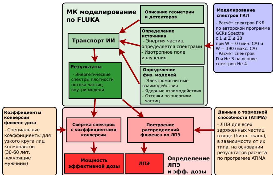
Рис. 3 — Общая блок-схема методики расчёта радиационного поля для модели космического аппарата с целью прогнозирования радиационного риска для космонавтов
