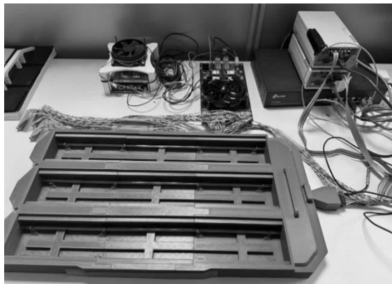
рис.2. Слева - испытательный стенд для калибровки плат; справа - контроллер HVSys SM-G761 и АЦП ADC64ECAL.
