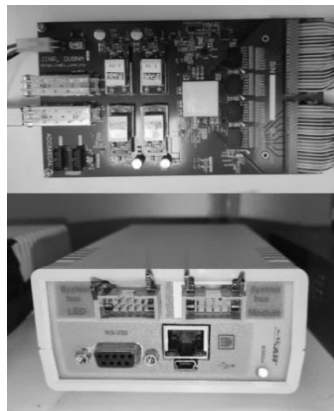
рис.2. Слева - испытательный стенд для калибровки плат; справа - контроллер HVSys SM-G761 и АЦП ADC64ECAL.
