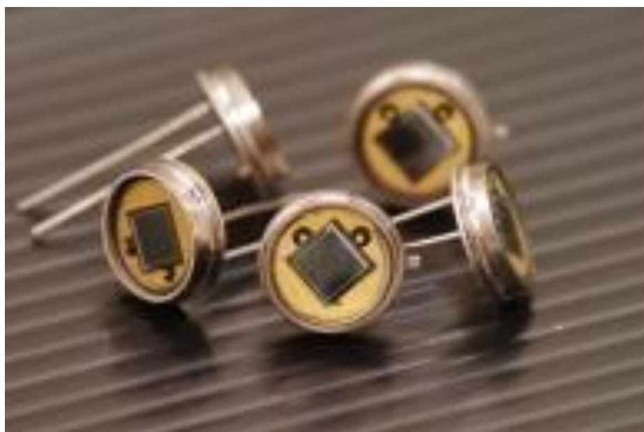
Рис. 18. Общий вид МЛФД-3А(Н) в корпусе КТ-2
