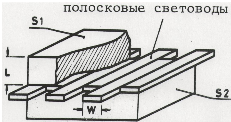
Рис. 41. Конструкция координатного сцинтилляционного счетчика
