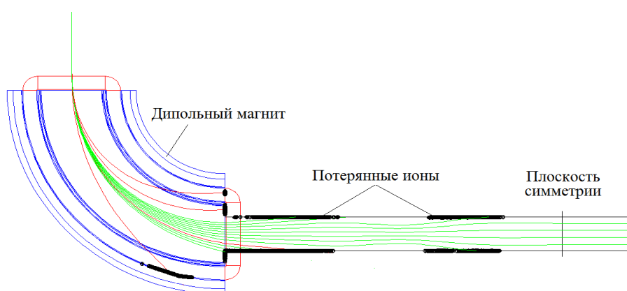
Рис. 12. Принцип работы системы отбора ионов.
