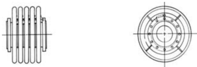
Рис. 4. Схема ускоряющей трубки
