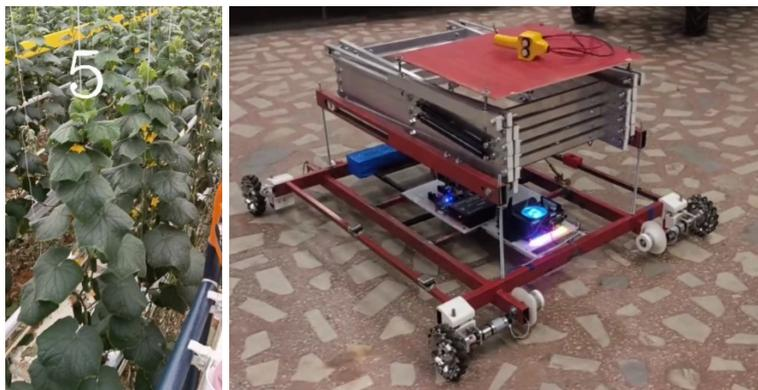
Рис.8. Слева – работа модели подсчета растений в ряду, справа – полнофункциональный прототип комплекса
