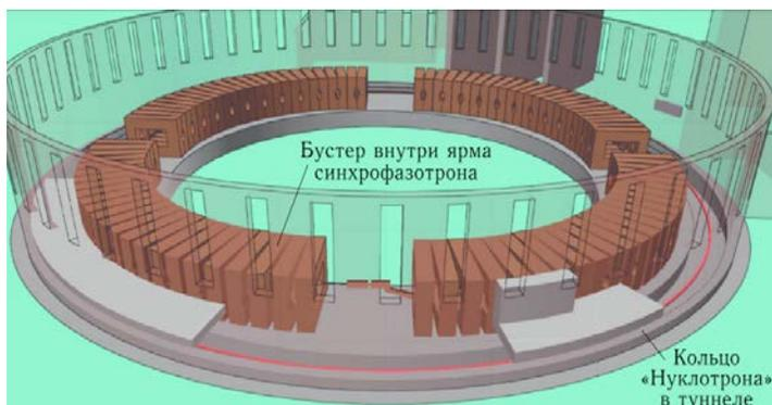
Рис. 1. Геометрия бустера и «Нуклотрона» внутри здания № 1 комплекса NICA ОИЯИ
