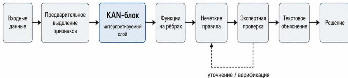
Рис. 1. Контур верифицируемого объяснения в гибридной системе на основе KAN
