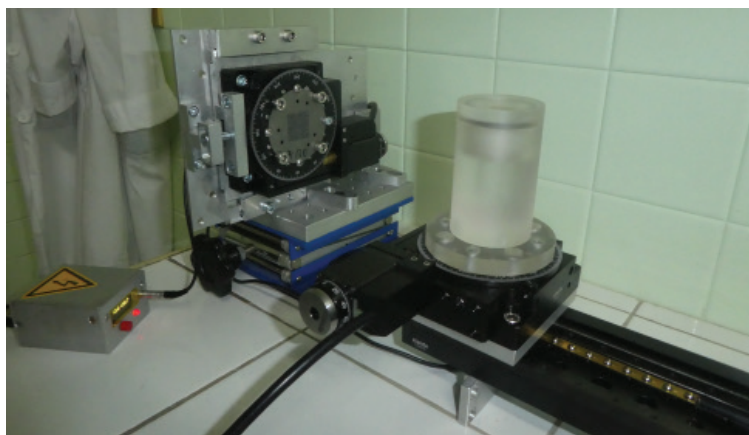
Рис. 2. Детектор ОФЭКТ и фантом, изготовленные в ОИЯИ, во время исследований на Кубе.
