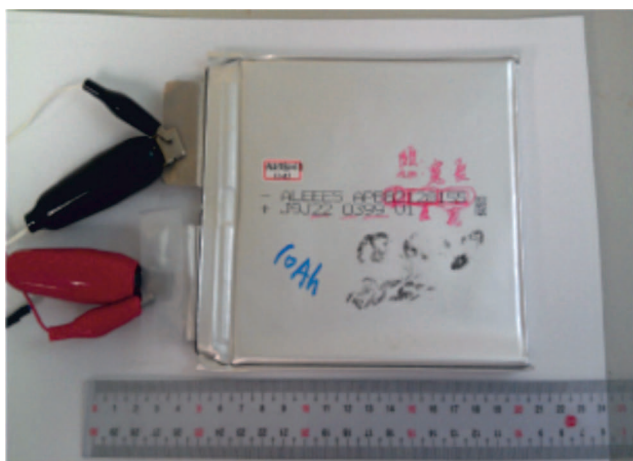
Рис. 1. Li-ионный аккумулятор (его емкость 10 А·ч) с токовыми выводами, через которые происходила его зарядка и разрядка
