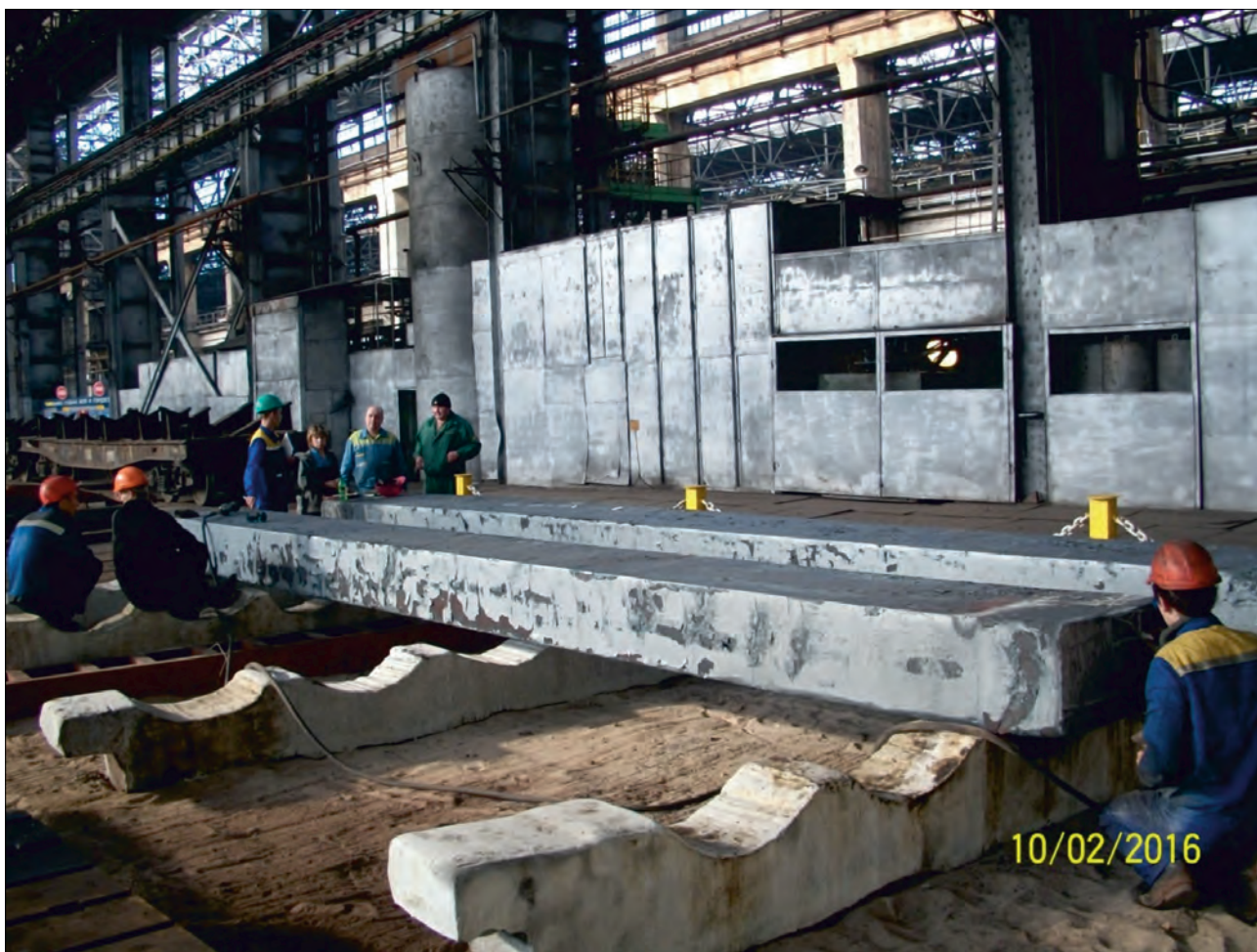
Новокраматорский машиностроительный завод (Краматорск, Украина), февраль 2016 г. Изготовление поковки 9-метровых балок магнитопровода MPD
