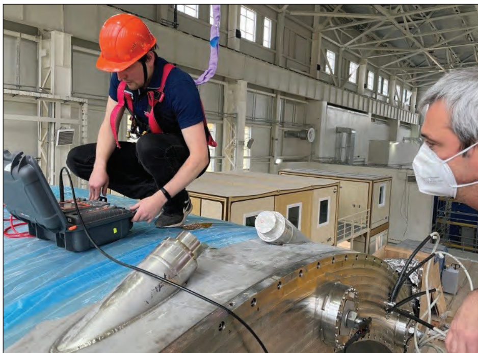
Рис. 3. Проверка целостности сверхпроводящих кабелей обмотки соленоида
