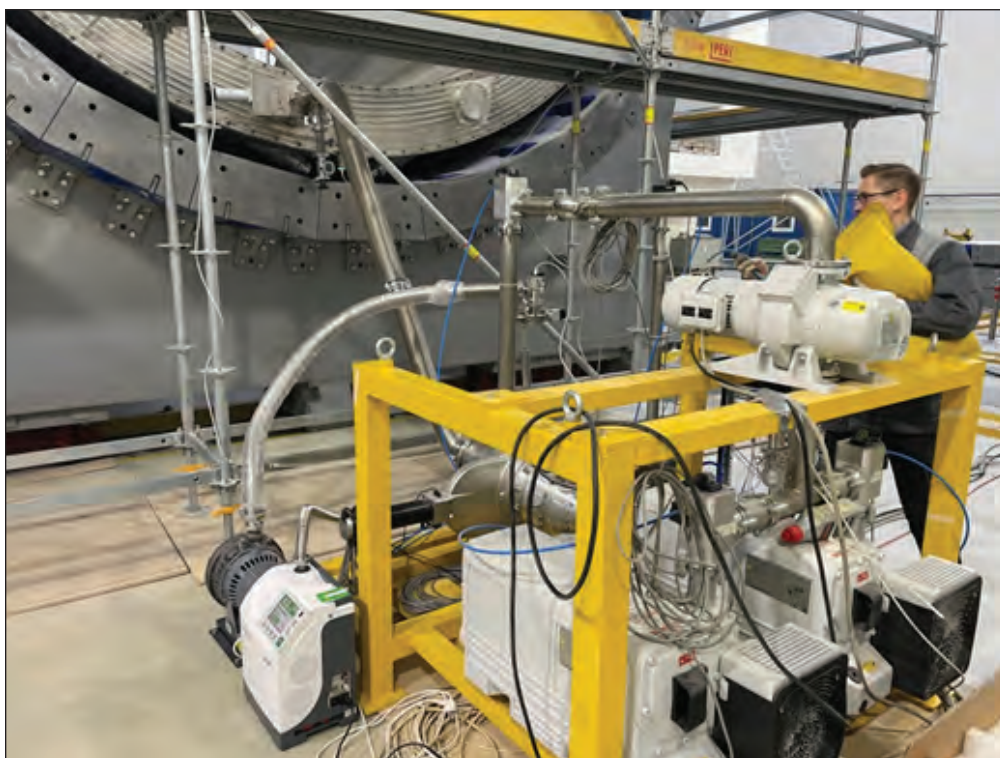
Рис. 1. Испытания и наладка вакуумной системы соленоида
