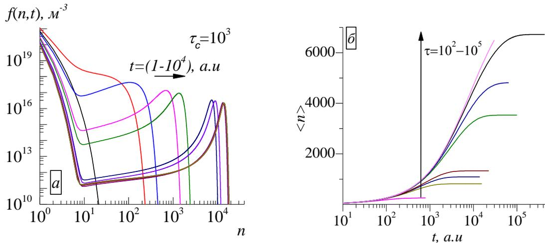
**Рис. 1.** Результаты моделирования кинетики кластерообразования в полярных растворах фуллерена. а) Модельная эволюция функции распределения кластеров по размерам  $f(n,t)$  на ранних этапах; б) Полная временная эволюция среднего числа частиц в кластере  $\langle n \rangle$  для разных значений параметра модели.
