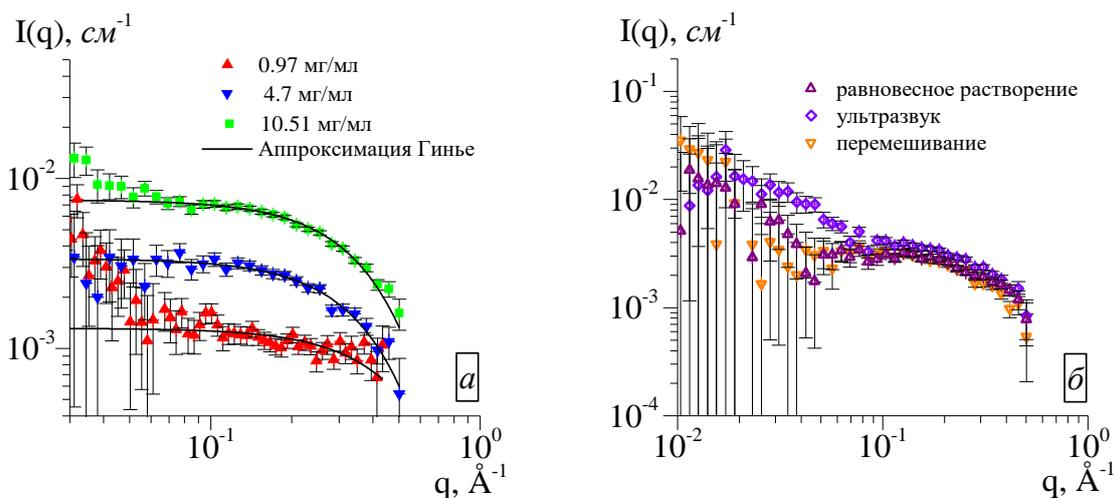
**Рис. 6.** Экспериментальные кривые МУРН для растворов  $C_{70}/CS_2$ : а) обработка ультразвуком во время растворения, б) сравнение результатов для насыщенных растворов, приготовленных разными методами.
