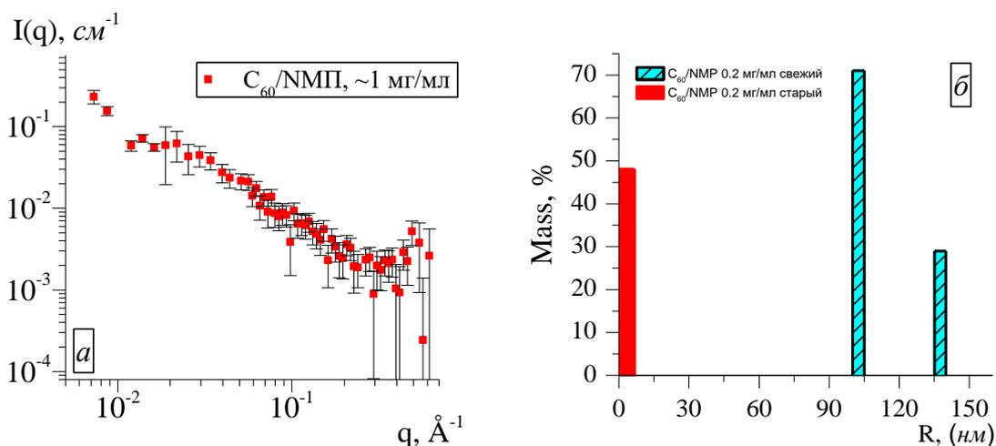
**Рис. 7.** Экспериментально исследования агрегации в растворах  $C_{60}/NMP$ : а) измерение методом МУРН одного раствора, б) аналогичные измерения методом ДСР для растворов разного возраста.
