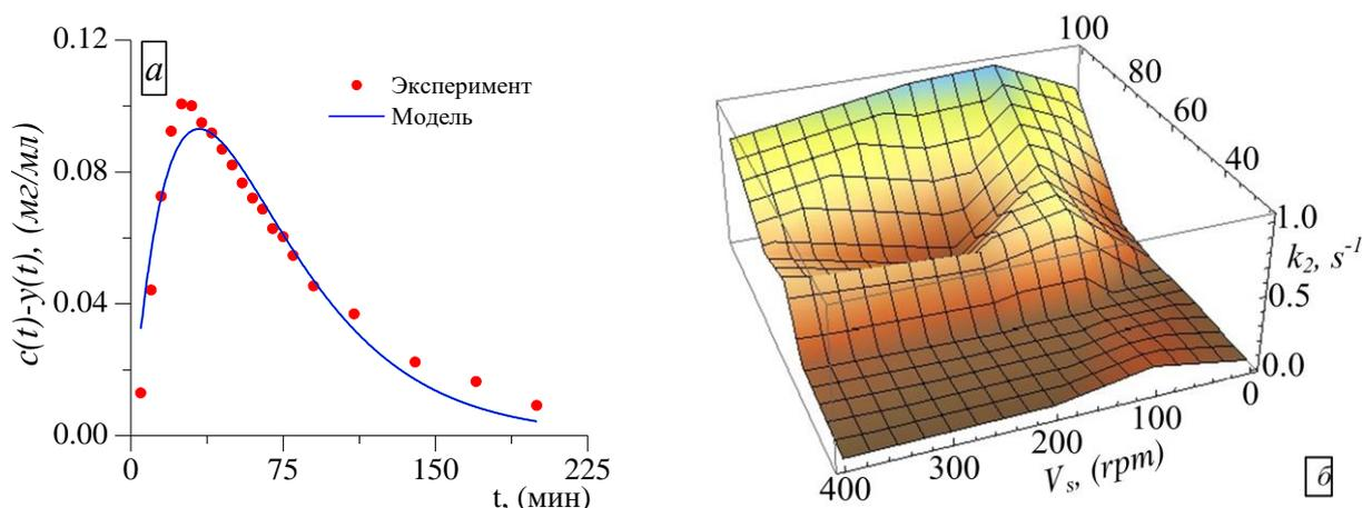
**Рис. 5.** УФ-Вид исследования кинетики растворения и комплексообразования в растворах  $C_{60}/NMP$ . а) Временная зависимость пика поглощения при 330 нм, насыщенный раствор при комнатной температуре, скорость перемешивания 400 об/мин; б) зависимость коэффициента  $k_2$  от температуры и скорости перемешивания.
