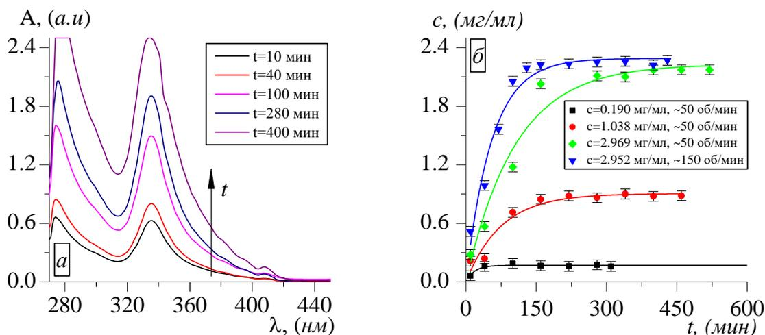
**Рис. 4.** Исследование кинетики растворения фуллерена  $C_{60}$  в неполярных растворах методом УФ-Вид спектрофотометрии. а) спектр поглощения раствора  $C_{60}/C_6H_6$  концентрации 2.4 мг/мл при комнатной температуре; б) символы - эволюция концентрации во времени для раствора  $C_{60}/C_6H_5CH_3$ , кривые – моделирование с помощью уравнения Нойеса-Уитни.
