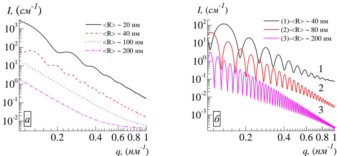
**Рис. 3.** Моделирование кривых малоуглового рассеяния нейтронов на кластерах в растворах  $C_{60}/NMP$ : а) для модели ограниченного роста, б) для двухступенчатой модели.
