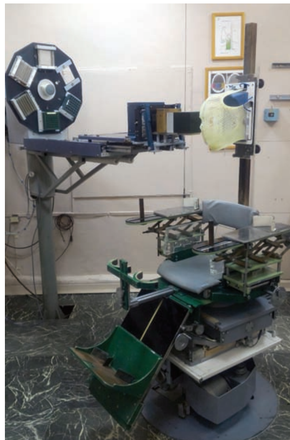
Рис. 3. Терапевтическое кресло в процедурной кабине МТК с установленной иммобилизирующей маской для проведения протонной терапии внутричерепных мишеней
