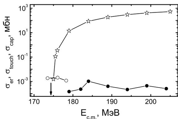
Рис. 5: Рассчитанные нами зависимости полных сечений касания  $\sigma_{\text{touch}}(E_{\text{с.м.}})$  (открытые звездочки) и образования остатков испарения  $\sigma_{\text{er}}(E_{\text{с.м.}})$  ( $\bullet$ ) от энергии налетающего иона в с.ц.м. в реакции  $^{48}\text{Ca} + ^{208}\text{Pb} \rightarrow ^{256}\text{No}$ . Экспериментальные данные  $\sigma_{\text{er}}(E_{\text{с.м.}})$  ( $\circ$ ) взяты из [10]. Стрелка показывает положение кулоновского барьера.
